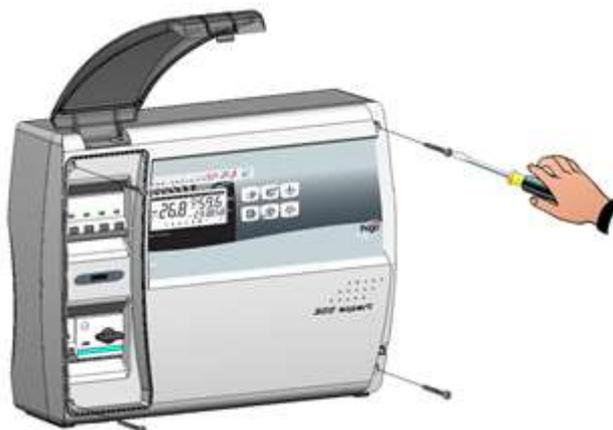
**Fig. 16:** Serrare il coperchio frontale con le 4 viti. Riposizionare la copertura delle viti sul lato destro.
