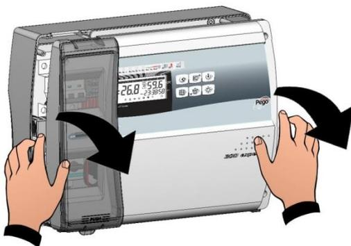
**Fig. 3:** Ouvrir le frontal du boîtier en soulevant et en faisant glisser les deux charnières jusqu'au fin de course. Fléchir les charnières et tourner le frontal de 180° vers le bas pour accéder à l'intérieur du tableau.
