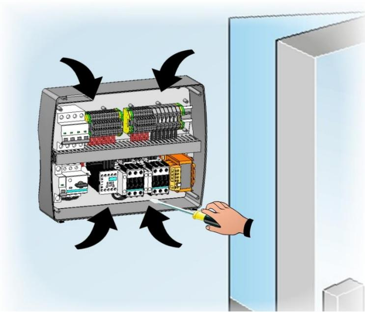
**Fig. 6:** En utilisant les trous préexistants fixer le fond du boîtier au moyen de quatre vis de longueur adéquate en relation à l'épaisseur de la paroi sur laquelle fixer le tableau. Interposer entre chaque vis et le fond du boîtier une rondelle en caoutchouc (fournies).
