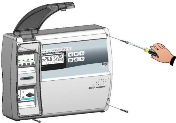
**Fig. 16:** Serrer le couvercle frontal avec les 4 vis, en réutilisant les O-ring présents sur la gorge de chaque vis. Replacer le cache des vis sur le côté droit.
