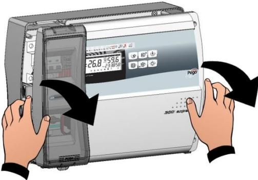
**Fig. 8:** Ouvrir le frontal du boîtier en soulevant et en faisant glisser les deux charnières jusqu'au fin de course. Fléchir les charnières et tourner le frontal de 180° vers le bas pour accéder à l'intérieur du tableau.
