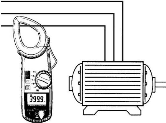
**Fig. 13:** Lorsque l'installation démarre pour la première fois il convient de bien calibrer l'intervention du disjoncteur inséré sur le circuit de puissance du compresseur. En utilisant l'ampèremètre en vérifier l'absorption effective.0
