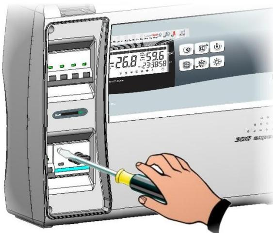
**Fig. 14:** Effectuer le calibrage du disjoncteur en fonction de l'absorption relevée. Toutefois la valeur configurée ne doit pas être supérieure à celle maximale prévue par le Fabricant du compresseur. Attention: une erreur de calibrage peut causer la panne du compresseur ou des interventions non voulues du disjoncteur.
