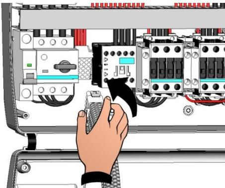
**Fig. 12:** Fléchir les charnières et tourner le frontal de 180° vers le bas pour accéder à l'intérieur du tableau et reconnecter le connecteur de connexion de la carte électronique
