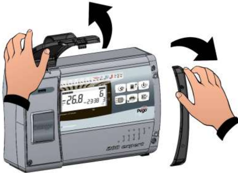
Fig. 1: Sollevare lo sportello trasparente di protezione slot USB e rimuovere la copertura delle viti sul lato destro.
