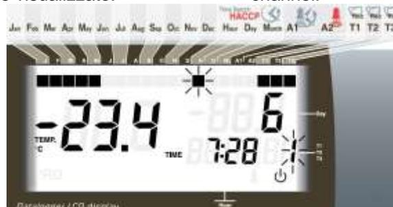
7. Con il tasto (▲) e (▼) si scorrono le registrazioni di temperatura relative al canale visualizzato. Se un valore registrato ha dato origine ad allarme di minima o di massima temperatura (vedi parametri A1 e A2 del 1° livello di programmazione), si accende il settore A1 o A2 della serigrafia ③.
