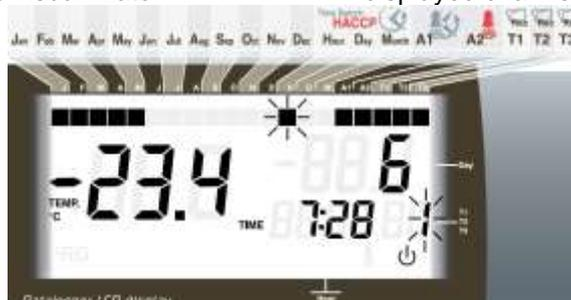
7. Con il tasto (▲) e (▼) si scrono gli allarmi di temperatura del canale visualizzato. Lo stato dell'ingresso digitale viene visualizzato per mezzo dell'accensione del segmento a sinistra del giorno.
