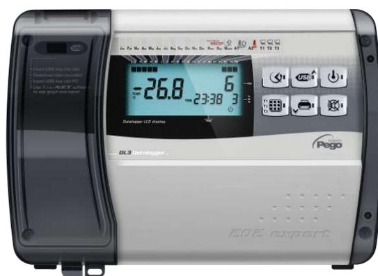
**Fig. 5:** Richiudere il coperchio frontale, ponendo attenzione che tutti i cavi siano all'interno della scatola e che la guarnizione della scatola sia correttamente alloggiata nella propria sede. Serrare il coperchio frontale con le 4 viti con una coppia non superiore 1 newton metro. Dare tensione di alimentazione al quadro ed effettuare una scrupolosa lettura/programmazione di tutti i parametri impostati.
