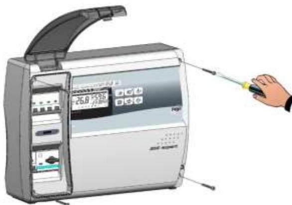
**Fig. 2 :** Dévisser les 4 vis de fixation du devant du tableau électrique. Undo the 4 fixing screws at the front of the box.
