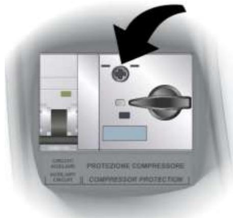
**Fig. 14 :** Effectuer l'étalonnage du disjoncteur en fonction de l'absorption mesurée. Dans tous les cas, la valeur configurée ne doit pas dépasser la valeur maximum prévue par le fabricant du compresseur.
