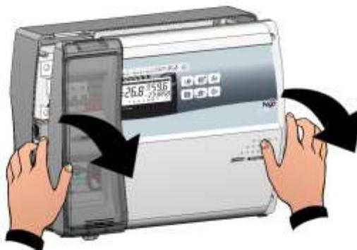
**Fig. 8:** Den Vorderteil des Schaltkastens öffnen und erheben und die beiden Scharniere bis zum Anschlag gleiten lassen. Die Scharniere biegen und zum Zugang zum Inneren des Schaltkastens um 180° nach unten drehen.
