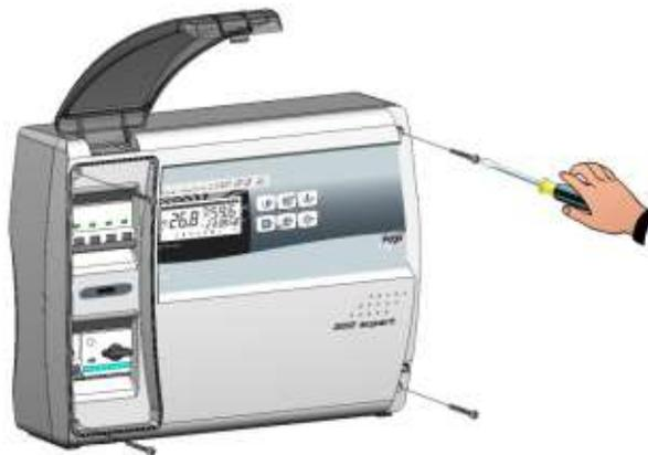
**Fig. 2:** Die 4 Befestigungsschrauben des Vorderteils des Schaltkastens abschrauben.
