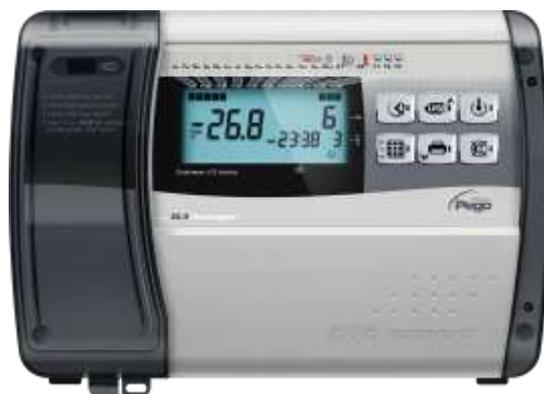
**Fig. 8:** Richiudere il coperchio frontale, ponendo attenzione che tutti i cavi siano all'interno della scatola e che la guarnizione della scatola sia correttamente alloggiata nella propria sede. Serrare il coperchio frontale con le 4 viti con una coppia non superiore 1 newton metro. Dare tensione di alimentazione al quadro ed effettuare una scrupolosa lettura/programmazione di tutti i parametri impostati.
