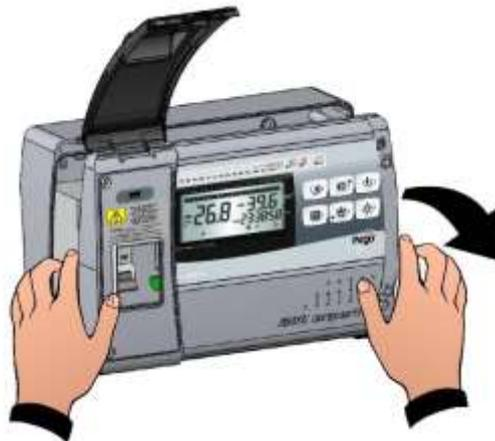
**Fig. 3 :** Ouvrir le devant du boîtier en soulevant et en faisant coulisser les deux charnières jusqu'à la butée d'arrêt. Fléchir les charnières et tourner le devant de 180° vers le bas, pour accéder à l'intérieur du tableau.
