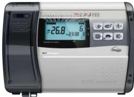
**Fig. 8 :** Refermez le couvercle frontal en veillant à ce que tous les câbles soient bien à l'intérieur du boîtier et que le joint de celui-ci soit bien dans son logement. Fixez le couvercle frontal à l'aide des 4 vis avec un couple ne dépassant pas 1 newton mètre.
