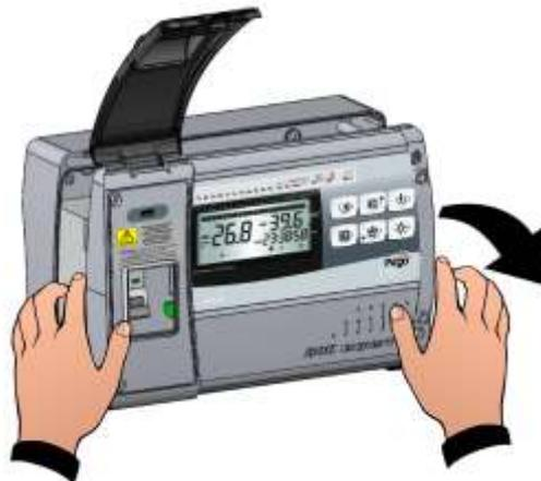
**Fig. 3:** Den Vorderteil des Gehäuses öffnen und erheben und die beiden Scharniere bis zum Anschlag gleiten lassen. Die Scharniere biegen und zum Zugang zum Inneren des Schaltkastens um 180° nach unten drehen
