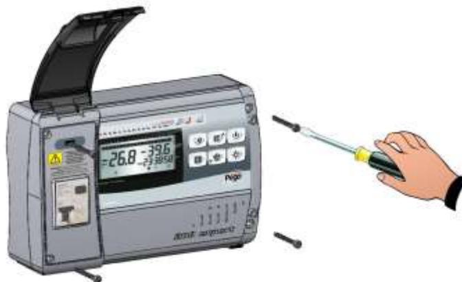
**Fig. 2:** Die 4 Befestigungsschrauben des Vorderteils des Gehäuses abschrauben.
