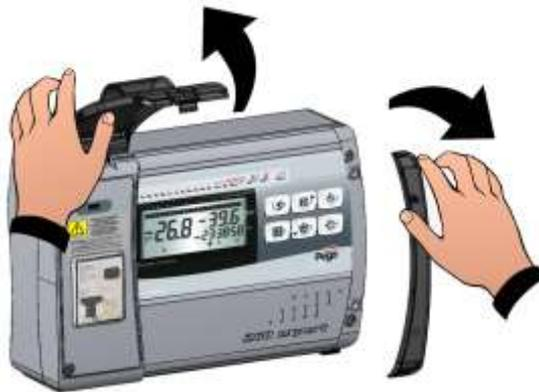
**Fig. 1:** Die transparente Schutzklappe des LS/FI-Schalters erheben und die Abdeckung der Schrauben auf der rechten Seite entfernen.
