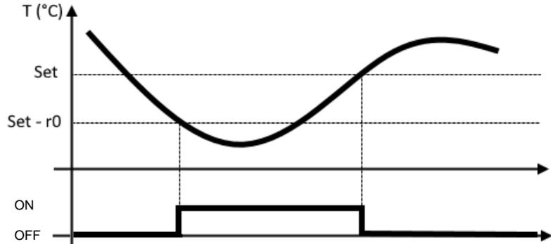
Salida de compresor o salida auxiliar configurada como "llamada calor" (parámetros AU1 / AU2)
