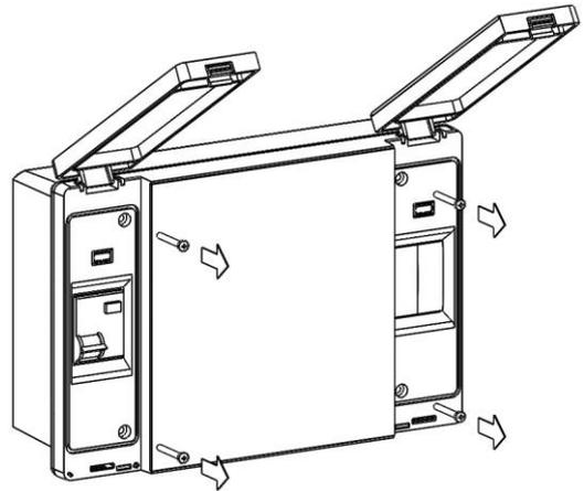
**Fig. 3:** Abra el frontal de la caja levantándolo y deslizando las dos bisagras hasta el final el tope. Doble las bisagras y gire el frontal 180° hacia abajo para acceder al interior del panel.
