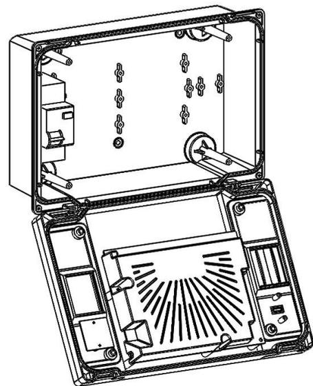
**Fig. 4:** Utilizando los tres orificios preexistentes, fije el fondo de la caja con tres tornillos de longitud adecuada en relación con el grosor de la pared en la que fijará el panel. Interponga una arandela de goma (suministrada) entre cada tornillo de fijación y el fondo de la caja. Luego reensamble la batería (si está presente).
