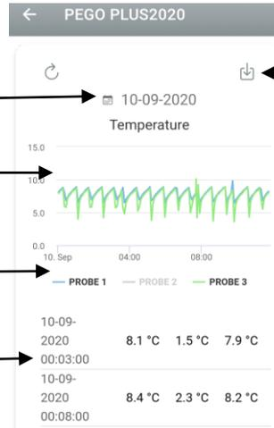
*Descarga de datos:* tocar para descargar datos en formato de tabla csv
