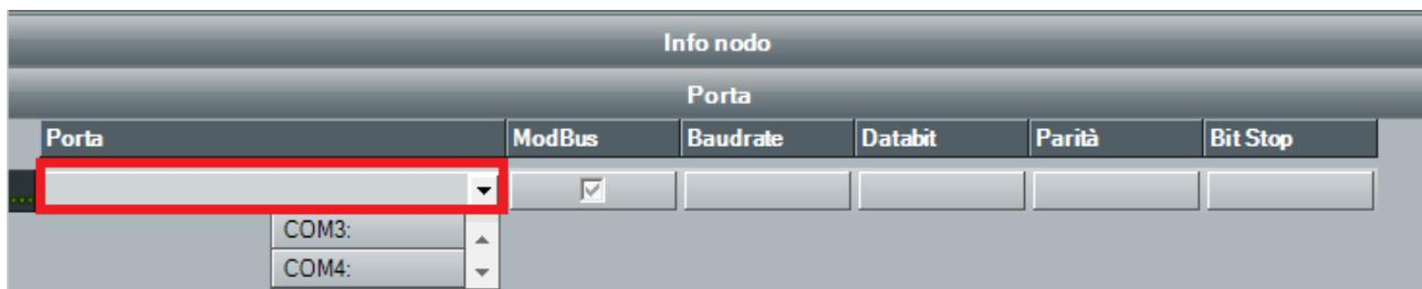
Es empfiehlt sich beide von der Schnittstelle 2TWR5485 verwendeten COM-Ports auszuwählen, um sie beide zu analysieren und den tatsächlich verwendeten Port nicht suchen zu müssen. Sobald der erste Port hinzugefügt wurde, reicht es aus, das darunterliegende Kästchen auszuwählen und den zweiten COM-Port auszuwählen.
