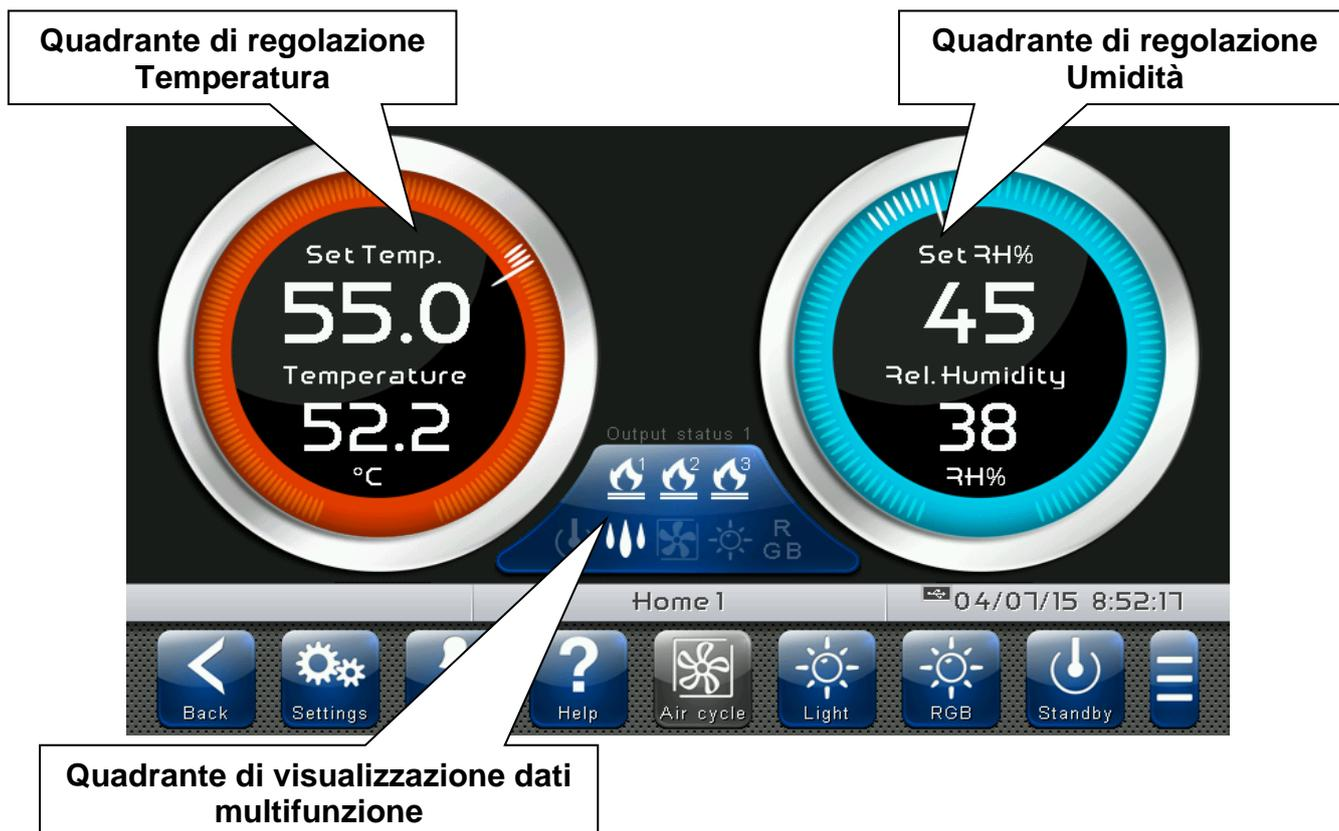
**Quadrante di regolazione Temperatura:** Visualizza tutto quanto riguarda la regolazione di temperatura, in particolare:
