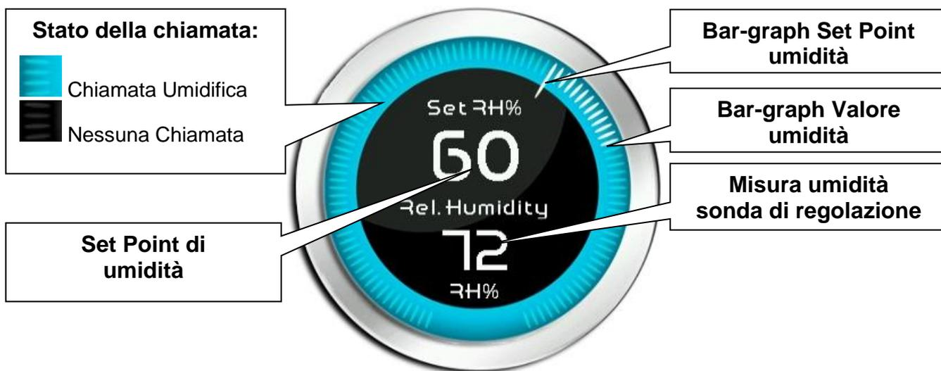
**Quadrante di visualizzazione dati multifunzione:** se toccato alterna ciclicamente la visualizzazione dati. Di seguito sono riportate le varie schermate e i relativi significati. Nota: Alcuni dati sono visualizzati solo se la relativa funzione è abilitata nei parametri di configurazione.
