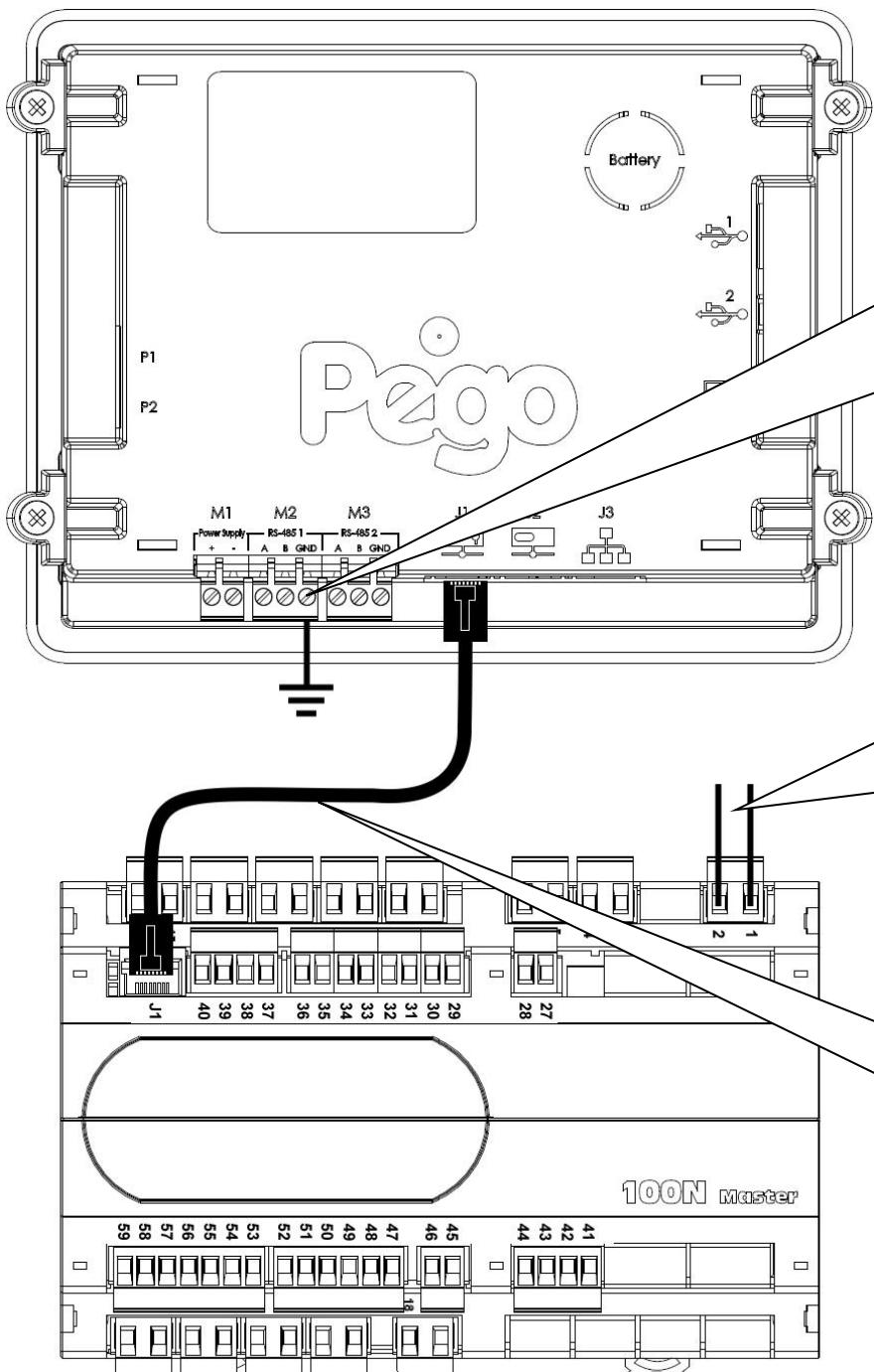
Collegare la terra al morsetto GND di M2 della consolle (terra funzionale). Questo collegamento contribuisce a limitare gli effetti dei disturbi elettromagnetici sul sistema di controllo.
