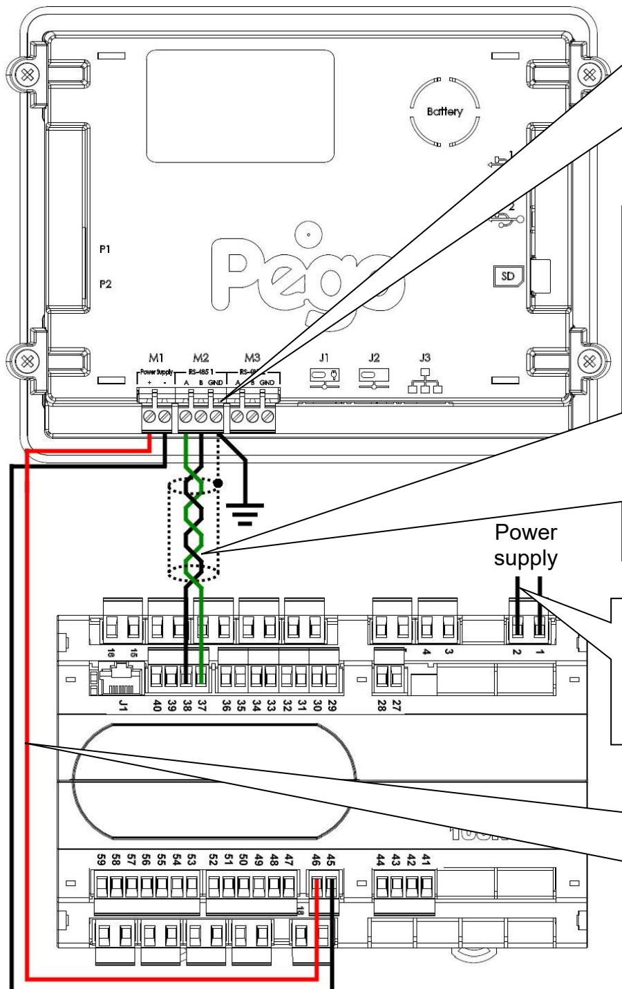
Collegare la terra al morsetto GND di M2 della consolle (terra funzionale). Questo collegamento contribuisce a limitare gli effetti dei disturbi elettromagnetici sul sistema di controllo. Il collegamento di terra deve essere effettuato in maniera conforme alle normative applicabili.
