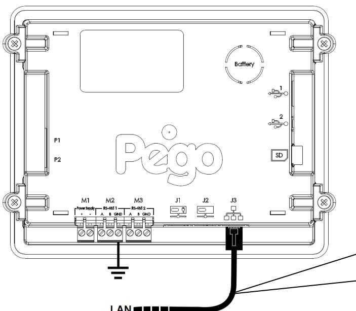
Collegare il cavo Ethernet con connettore RJ45 all'ingresso J3 della console Vision Touch. Collegare l'altra estremità del cavo alla rete LAN esistente o al pc.
