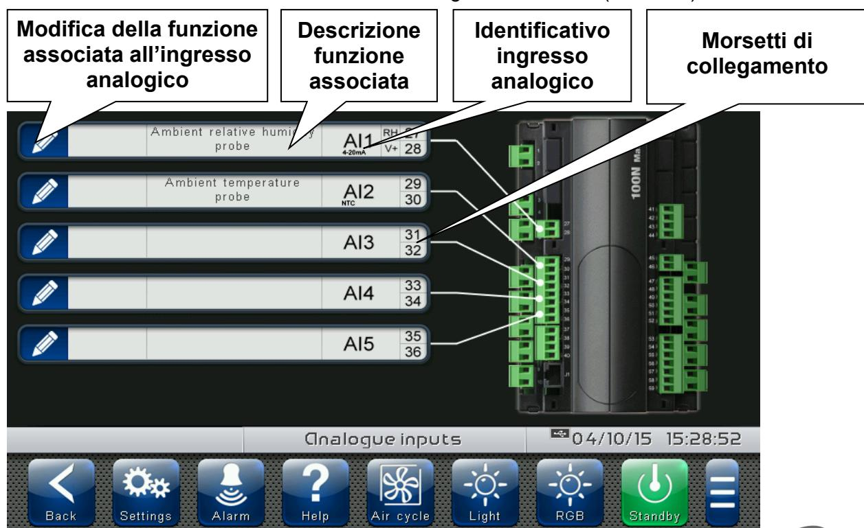
“Stato I/O” consente di visualizzare lo stato di ogni ingresso/uscita del 100N MASTER3 collegato.
