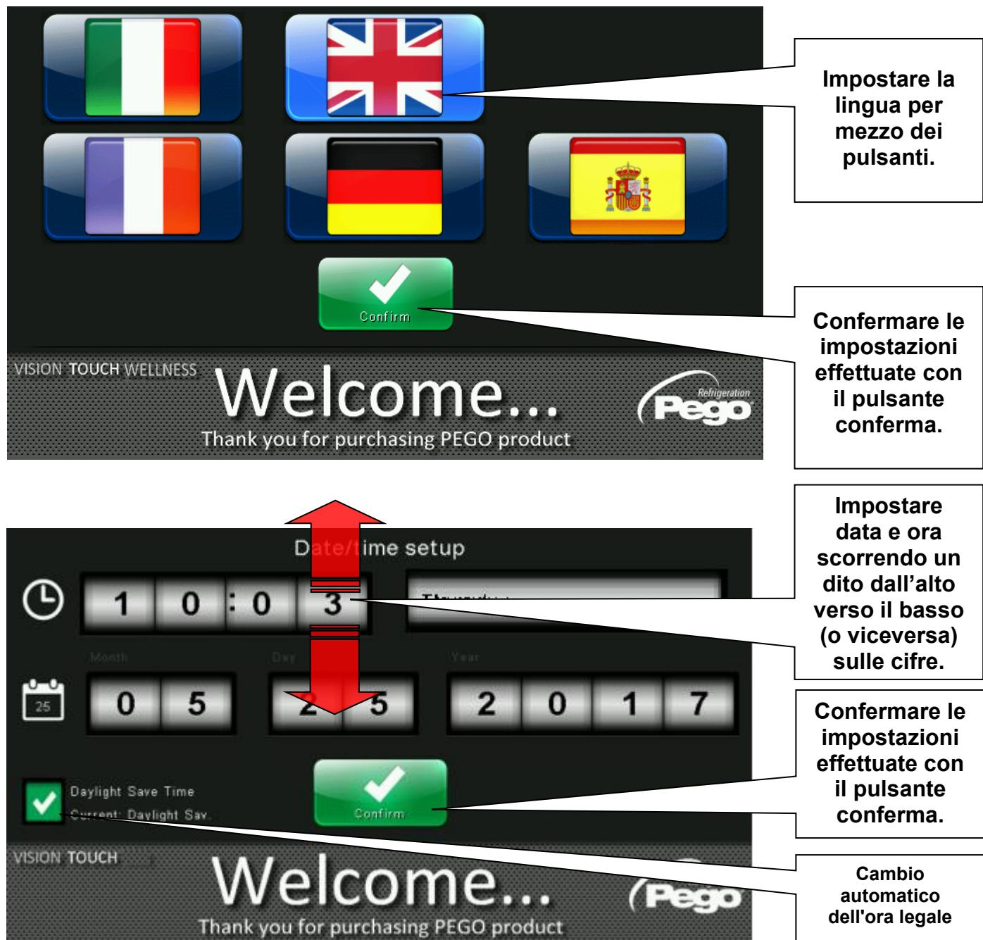
Ad ogni accensione del controllo viene visualizzato un pop-up informativo che riporta data ed ora di avvio, con richiesta di acquisizione da parte dell'utente per mezzo della pressione di un pulsante di "Ok". Questo permette di verificare l'eventuale ritorno da un blackout elettrico.
