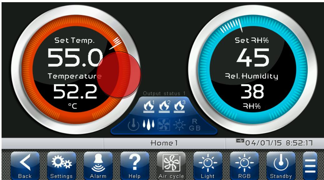
**Modifica pagine Home, Cambio Set Point con Wheel:** Una volta entrati in modalità di modifica della Home 1 è possibile cambiare i Set Point di umidità e temperatura attualmente in uso. Ruotare in senso orario per aumentare o in senso antiorario per diminuire il valore della Wheel del Set Point da modificare o in alternativa agire sui pulsanti più e meno. Confermare quindi i nuovi valori con il pulsante verde conferma.
