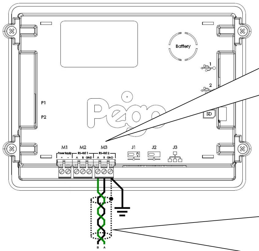
Collegare la terra al morsetto GND di M3 della console (terra funzionale). Questo collegamento contribuisce a limitare gli effetti dei disturbi elettromagnetici sul sistema di controllo.
