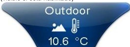
Este cuadrante se visualiza sólo si la variable "Parametros > Recambio del aire automatico > EEs Habilitación de ahorro de energía = 1" y si la entrada analógica correspondiente estan configuradas.
