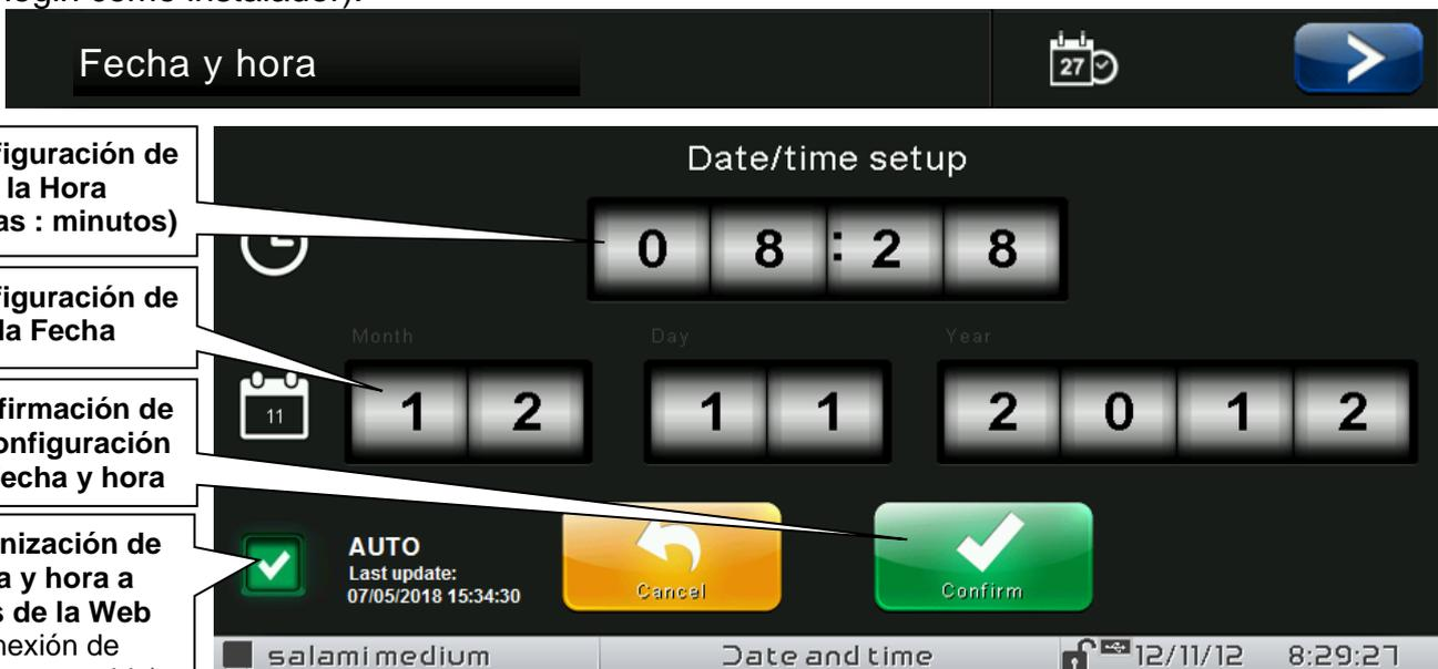
Si la sincronización automática a través de la Web está activa, el control se conecta a un servicio externo que determina automáticamente la zona horaria correcta y establece la fecha y la hora considerando cualquier horario de verano / invierno. El estado del último intento de sincronización (denominado "Last update") puede ser:
