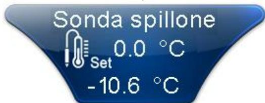
Este cuadrante se visualiza sólo si la variable "Parametros > Sonda producto > EnS Habilitación sonda producto = 1 o 2" y si la entrada analógica correspondiente estan configuradas.
