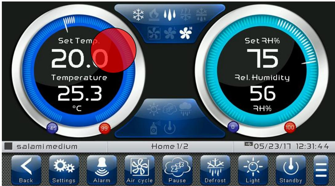
Una vez en el modo de edición, puede cambiar el Set Point de humedad y temperatura en uso girando el aro en sentido horario para aumentar, o en sentido contrahorario para bajar el valor del set point que desea modificar. Alternativamente, es posible utilizar las teclas más (+) y menos (-). Confirme los nuevos valores con la tecla verde "Confirmar", o toque "Cancelar" para volver a la pantalla de visualización.
