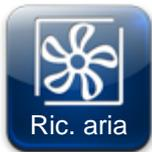
**RECAMBIO DEL AIRE MANUAL:** Activa un recambio del aire manual o desactiva un recambio del aire automático o manual en marcha (Activación retardada).
