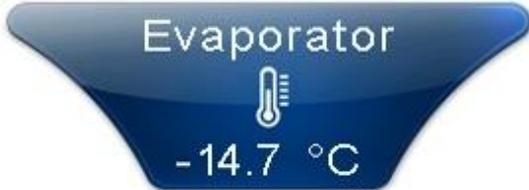
Este cuadrante se visualiza sólo si la variable "Parametros > Descongelación > dE Habilitación sonda evaporador = 1" y si la entrada analógica correspondiente estan configuradas.
