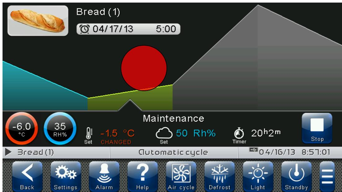
A questo punto viene visualizzato un grafico con gli andamenti dei setpoint di temperatura e umidità impostati in ogni fase del programma. È possibile visualizzare la configurazione completa di una fase (e modificare i setpoint, se l'utente è abilitato), premendo il pulsante
