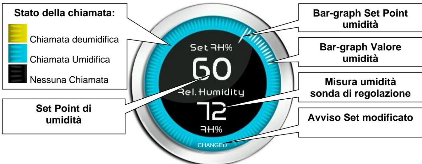
**Quadrante di visualizzazione dati multifunzione:** se toccato, alterna ciclicamente la visualizzazione dati. Di seguito sono riportate le varie schermate e i relativi significati.
