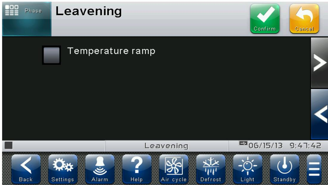
Questa funzione risulta utile per uniformare nel processo di lievitazione prodotti di pezzature e tipologie diverse. Il suo utilizzo tipico è la configurazione di una fase di lievitazione come risveglio con abilitata l'opzione di "Variazione temp. progressiva" ed una fase di lievitazione vera e propria che manterrà alla temperatura di lievitazione il prodotto per il tempo necessario.
