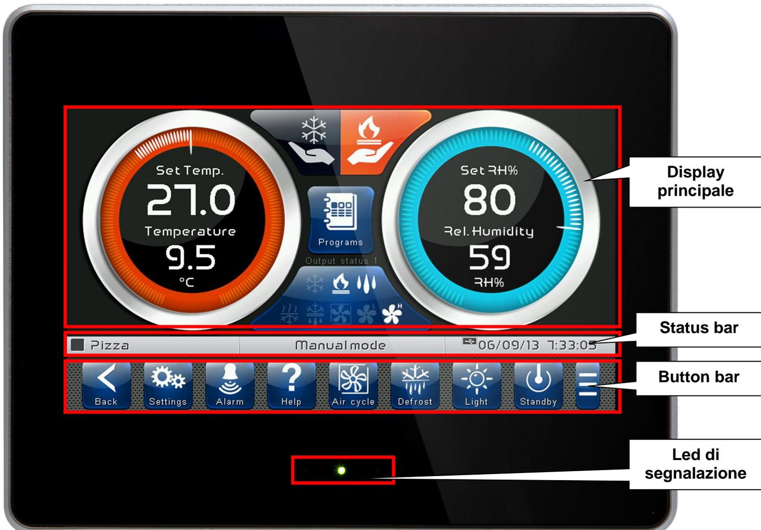
Nella sezione del display principale vengono visualizzate le pagine di lavoro, impostazione e settaggio, in base alla posizione in cui ci si trova (come per esempio Home, Configurazione, Fase). La descrizione particolareggiata delle varie pagine verrà descritta più avanti in questo manuale.
