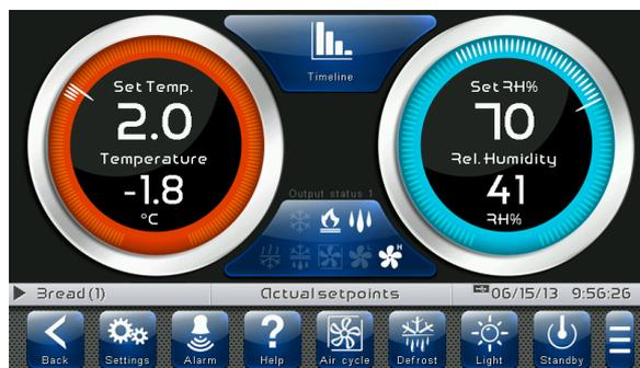
La pagina “MODO MANUALE” permette la selezione della modalità manuale da utilizzare (caldo/freddo), la visualizzazione e modifica delle regolazioni di Temperatura e Umidità, l’accesso alla pagina delle ricette tramite il tasto ‘Seleziona programma’.
