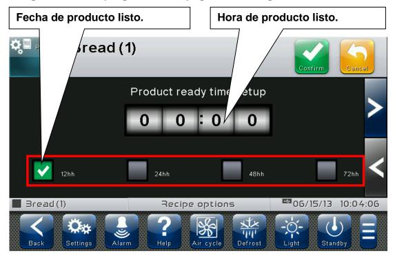
La página de configuración de productos listos también se propone después de presionar la tecla PLAY para iniciar el programa, si está habilitada la función 'Cambiar tiempo de preparación del producto', seleccionable en el submenú "Contraseña" => "Configurar funciones de usuario" (necesario iniciar sesión como instalador).
