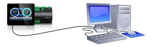
La tarjeta de red del PC tiene que ser configurada de manera que tenga habilitada la asignación de dirección por medio del DHCP. En este caso la Vision Touch PAN y el PC, por no haber encontrado algún server DHCP, tomarán la dirección IP por defecto previsto en la clase de direccionamiento **169.254.xxx.xxx**. Para conectarse al aparato, será necesario abrir un browser y digitar en la barra de las direcciones la siguiente orden:
