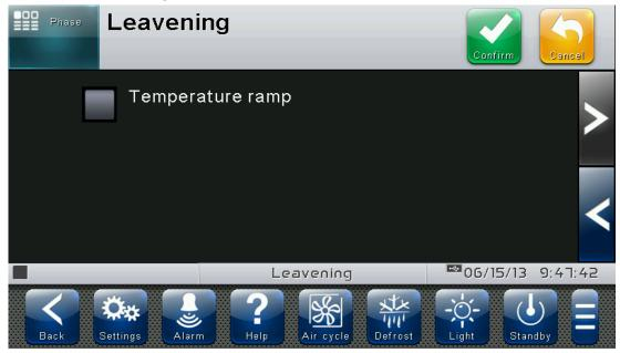
Esta función es útil para estandarizar productos de diferentes tamaños y tipos en el proceso de fermentación. Su uso típico es la configuración de una fase de fermentación como un reavivamiento con la opción "Temp. progresivo "y una verdadera fase de fermentación que mantendrá el producto durante el tiempo necesario a la temperatura de fermentación.
