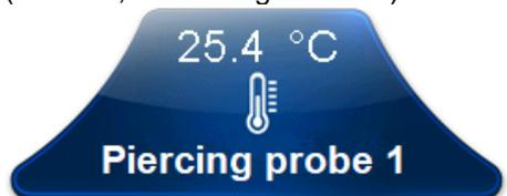
Dieser Bereich wird nur angezeigt, wenn die Größe „Parameter > Kerntemperaturfühler > EnS > 0“ und der entsprechende Analogeingang eingestellt wurden.
