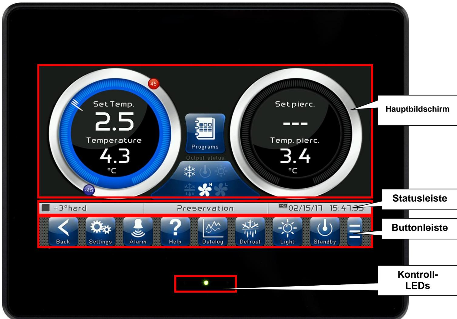
Auf dem Hauptbildschirm werden die Seiten zum Betrieb, den Einstellungen und der Programmierung angezeigt, abhängig vom Bereich, in dem man sich gerade befindet (z.B. Home, Konfiguration, Phase). Die einzelnen Seiten werden später in diesem Handbuch genauer beschreiben.
