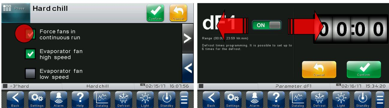
„Bearbeiten“-Modus auf den Seiten Home 1 und 2: Auf einer der Home-Seiten den Bildschirm außerhalb der Schaltflächen länger als drei Sekunden lang berühren, um in den Bearbeitungsmodus für diese Seite zu wechseln. Um diesen Modus zu verlassen, die Schaltfläche „Back“ drücken oder warten, bis er nach einer Minute Inaktivität automatisch beendet wird.
