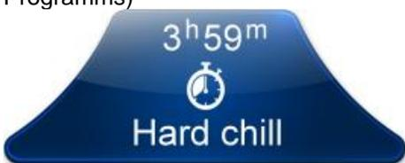
Dieser Bereich wird nur angezeigt, wenn gerade ein Programm ausgeführt wird. Zeigt den Namen und die verbleibende Zeit am Ende der aktuellen Phase an.
