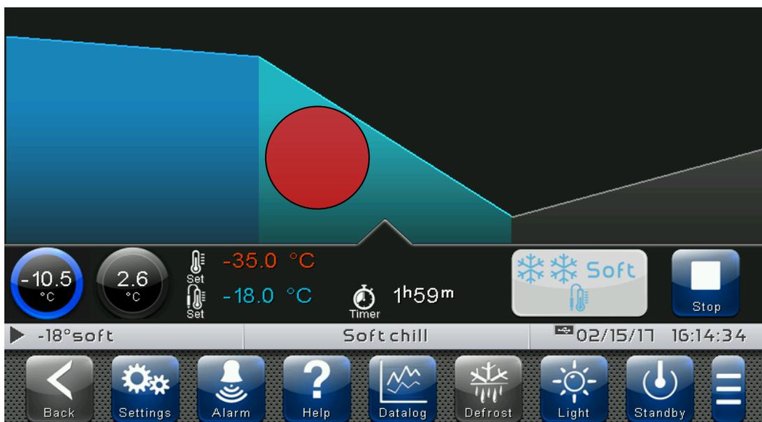
An dieser Stelle wird ein Diagramm angezeigt, das die Trends der in jeder Phase des Programms eingestellten Sollwerte für Raumtemperatur (rote Linie) und Produkt (blaue Linie) zeigt. Sie können die vollständige Konfiguration einer Phase anzeigen (aber nicht ändern), indem Sie die
