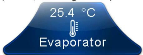
Dieser Bereich wird nur angezeigt, wenn die Größe „Parameter > Abtauen > dE Verdampfersonde freischalten = 1“ und der entsprechende Analogeingang eingestellt wurden.
