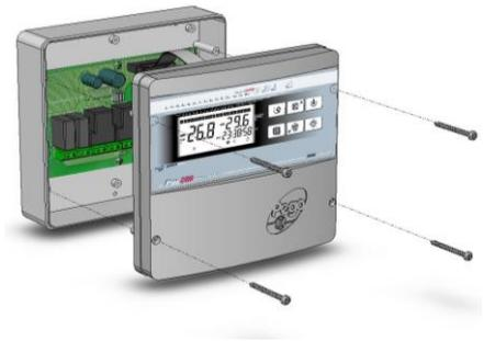
**Fig. 2:** Staccare il connettore J2 che collega le due schede elettroniche tramite il cavetto piatto (flat).
