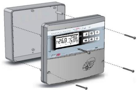
**Fig. 2 :** Utilisez les trois trous déjà existants pour fixer le fond du boîtier au moyen de trois vis. La longueur des vis dépend de l'épaisseur de la paroi sur laquelle vous souhaitez appliquer le contrôleur. Mettez une rondelle en caoutchouc (fournie) entre chaque vis de fixation et le fond du boîtier.
