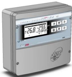
**Fig. 3 :** Refermez le couvercle frontal en veillant à ce que tous les câbles soient bien à l'intérieur du boîtier et que le joint de celui-ci soit bien dans son logement. Fixez le couvercle frontal à l'aide des 4 vis prévues à cet effet (réutilisez les joints toriques présents sur la gorge de chaque vis).
