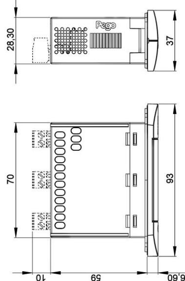
FISSAGGIO A PANNELLO PER MEZZO DI DUE CLIPS POSTERIORI
