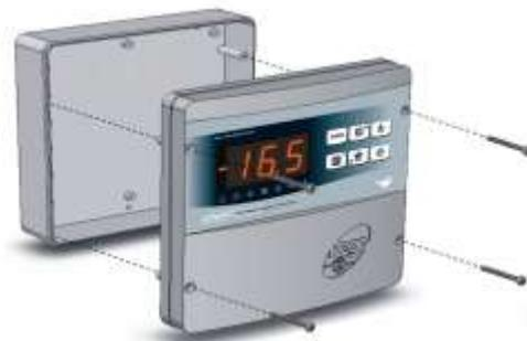
**Fig. 2:** Utilizzando i tre fori preesistenti, fissare il fondo della scatola tramite tre viti di adeguata lunghezza in relazione allo spessore della parete su cui fissare il quadro. Interporre tra ogni vite di fissaggio ed il fondo della scatola una rondella in gomma (fornita).
