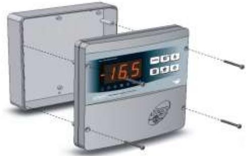
**Fig. 2:** Utilizando los tres orificios preexistentes, fije el fondo de la caja utilizando tres tornillos de longitud adecuada al grosor de la pared sobre la que se desea fijar el cuadro. Coloque entre cada tornillo de fijación y el fondo de la caja una arandela de goma (suministrada).
