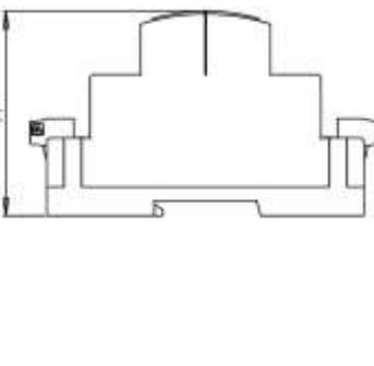
FISSAGGIO A PANNELLO DEL DISPLAY ECHO PER MEZZO DI DUE VITI FRONTALI
