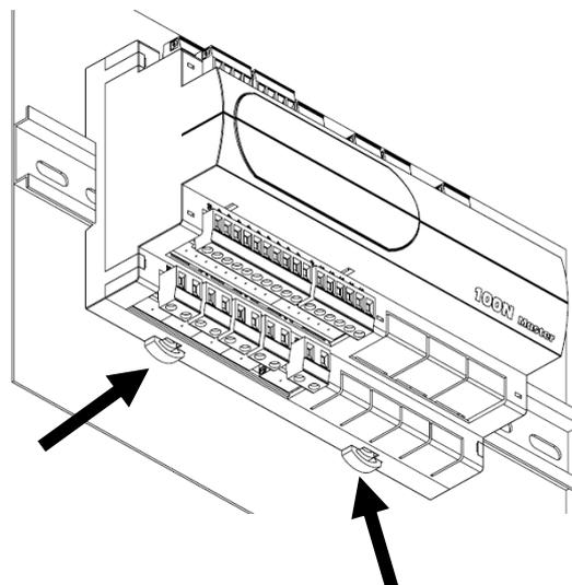
**Fig. 2** : Fixer le pupitre **VISION SC600** au moyen de deux vis à insérer dans les logements présents sous l'écusson des touches.
