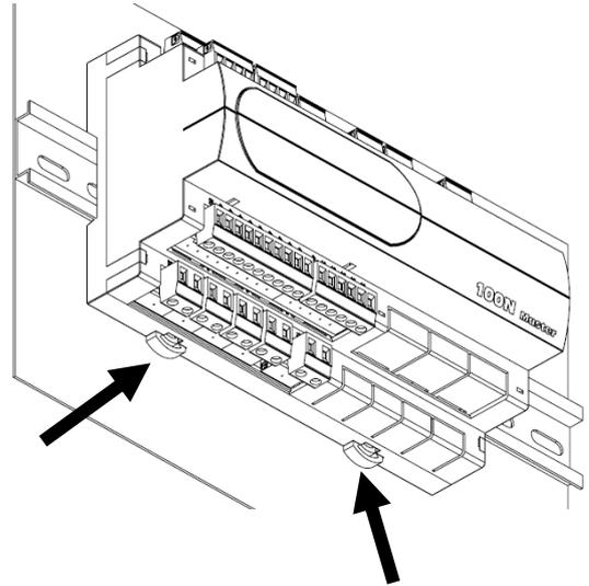
**Fig. 2:** Fissare la console VISION THR per mezzo di due viti da inserire negli alloggiamenti presenti sotto la mostrina tasti.
