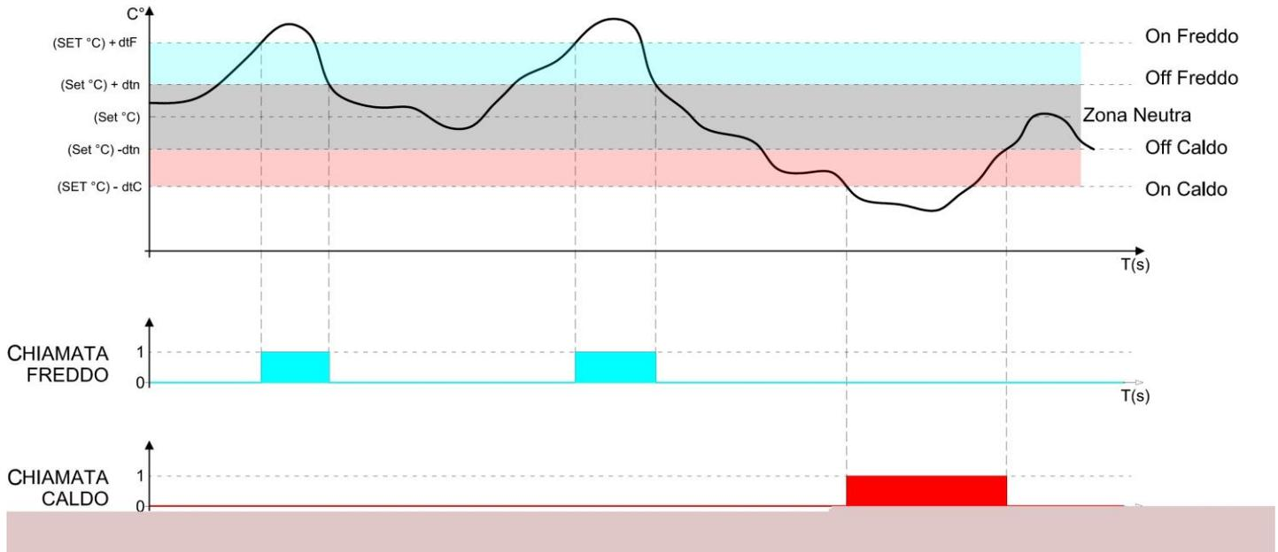
El parámetro C1 introduce un retraso entre un apagado y la sucesiva reactivación del frío. El calor se puede desactivar con el parámetro EnH (Enh=0 deshabilita el relé del calor en todas las condiciones).
