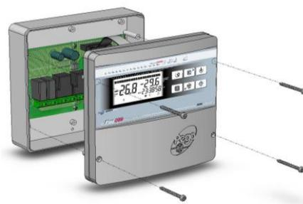
**Fig. 2:** Staccare il connettore J2 che collega le due schede elettroniche tramite il cavetto piatto (flat).
