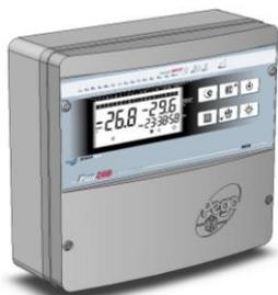
**Fig. 3:** Collegare il cavetto piatto, richiudere il coperchio frontale, ponendo attenzione che la guarnizione della scatola sia correttamente alloggiata nella propria sede.
