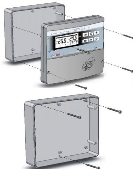
**Fig. 2:** Utilizzando i tre fori preesistenti fissare il fondo della scatola tramite tre viti di adeguata lunghezza in relazione allo spessore della parete su cui fissare il quadro. Interporre tra ogni vite di fissaggio ed il fondo della scatola una rondella in gomma (fornita).
