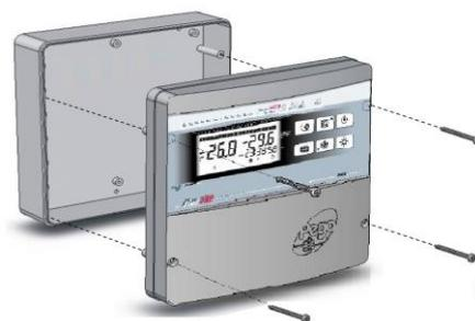
**Fig. 2 :** Utilisez les trois trous déjà existants pour fixer le fond du boîtier au moyen de trois vis. La longueur des vis dépend de l'épaisseur de la paroi sur laquelle vous souhaitez appliquer le contrôleur. Mettez une rondelle en caoutchouc (fournie) entre chaque vis de fixation et le fond du boîtier.
