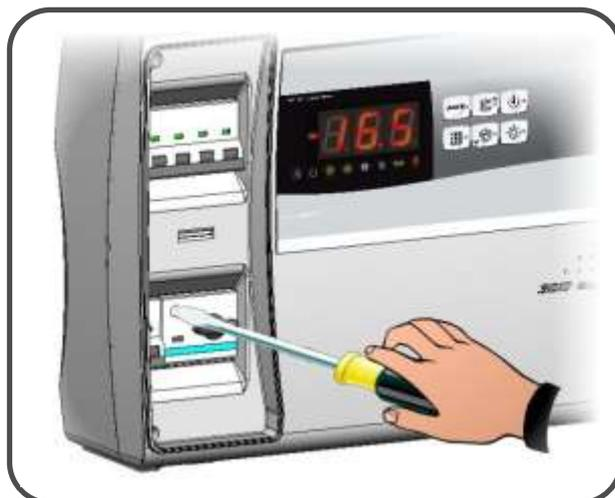
**Fig.17:** Per effettuare la taratura agire sulla vite di regolazione presente sul fronte del salvamotore.
