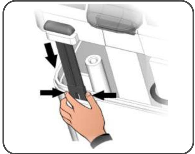
**Fig. 13 :** En faisant fléchir les charnières, faites basculer la façade de 180° vers le bas pour accéder à l'intérieur du contrôleur et reconnectez le connecteur de la carte électronique.
