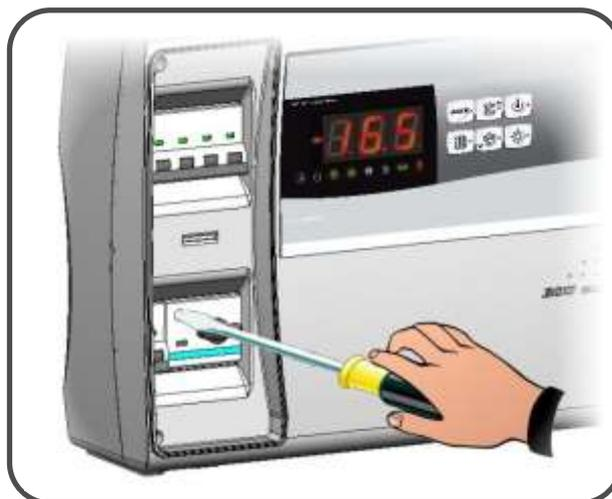
**Fig. 17 :** Étalonnez en agissant sur la vis de réglage située en façade du disjoncteur.
