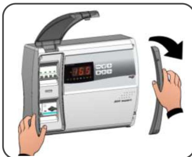
**Fig. 3:** Desenrosque los 4 tornillos que fijan el frontal de la caja.
