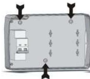
**Fig. 7 :** Assemblez la façade et le fond du boîtier en introduisant les charnières dans les logements prévus à cet effet ; ouvrez le tout à 180° vers le bas pour accéder à la carte électronique.
