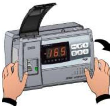
**Fig. 5:** Ejerza presión sobre los dedos de cada bisagra para extraerla de su sede y extraiga completamente el frontal.
