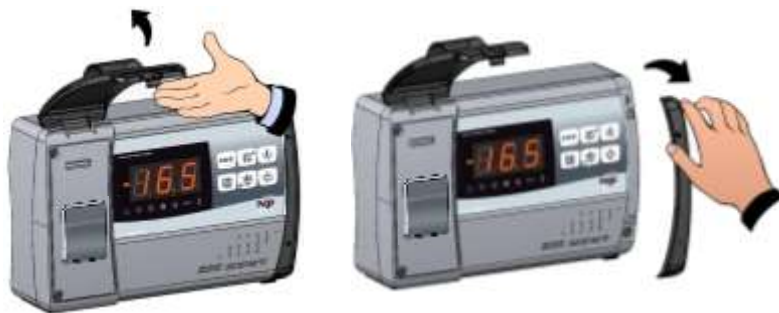
Fig. 1: Sollevare lo sportello trasparente di protezione del magnetotermico differenziale e rimuovere la copertura delle viti sul lato destro.
