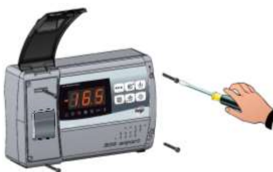
Fig. 2: Svitare le 4 viti di fissaggio del frontale della scatola.
