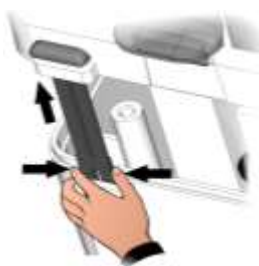
Fig. 5: Esercitare una pressione sui lati di ogni singola cerniera per estrarla dalla propria sede e rimuovere completamente il frontale.
