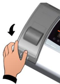
Fig. 3: Chiudere lo sportello trasparente di protezione del magnetotermico differenziale.
