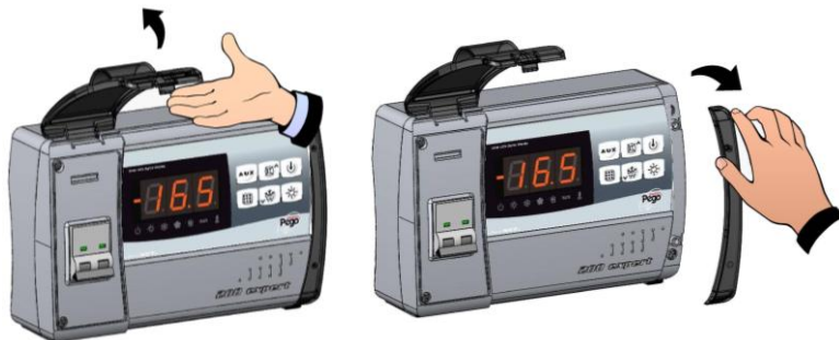
Fig. 1: Sollevare lo sportello e rimuovere la copertura delle viti sul lato destro.
