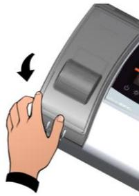
**Fig. 4:** Aprire il frontale della scatola sollevandolo e facendo scorrere le due cerniere fino a fine corsa.
