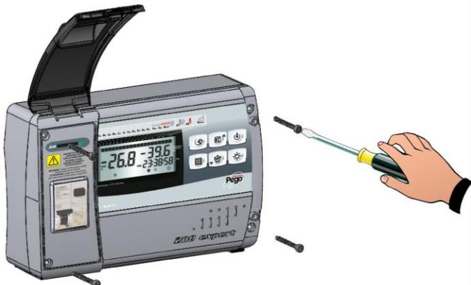
**Fig. 2:** Desenrosque los 4 tornillos del frontal de la caja.
