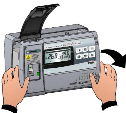
**Fig. 3:** Abra el frontal de la caja levantándolo y haciendo desplazar las dos bisagras hasta el final de carrera. Fleccione las bisagras y gire el frontal de 180 ° hacia abajo para acceder al interior del cuadro.
